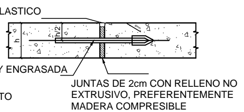
⑤ JUNTA DE CONSTRUCCION a) Tipo ensamblada (Longitudinal); b) Tipo a tope (Transversal)
